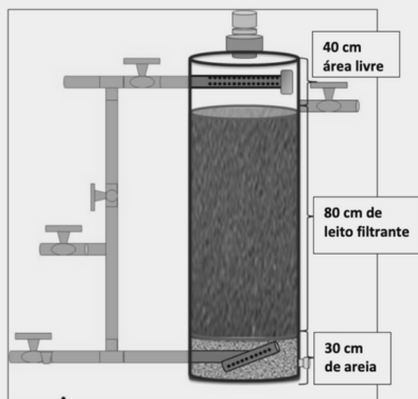
VISÃO INTERNA DO FILTRO
